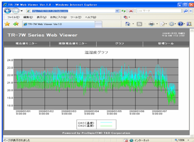
図1. マシンルームの温度記録のモニタ画面
